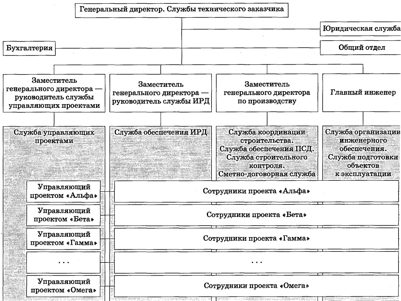
Рис. 3. Организационная структура управления службы технического заказчика, построенная по проектному принципу
