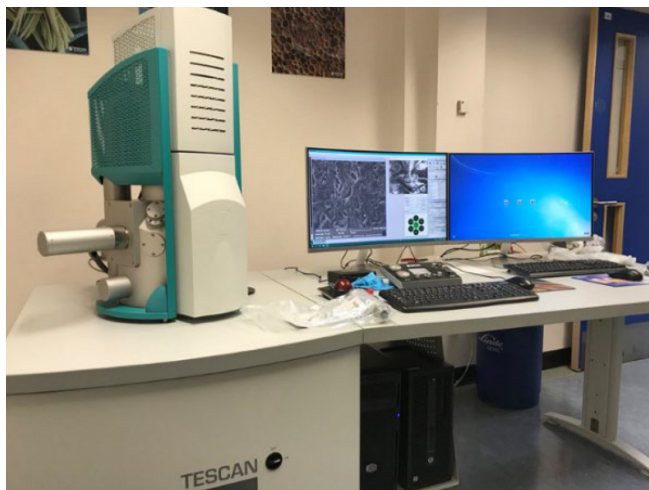
Рис. 65. Сканирующий электронный микроскоп TESCAN VEGA
