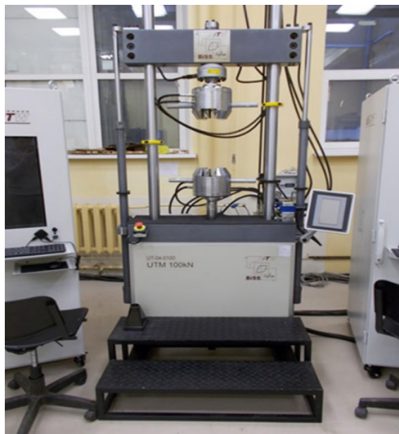
Рис. 64. Испытательная система UTM 100 кН
