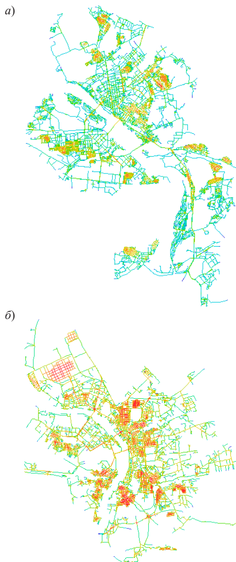
Рис. 3. Интеграционный центр планировочной структуры с радиусом анализа осевой карты R = 5 для городов: а) Новосибирск и б) Омск
