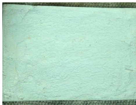
Рис. 1.39. Фрагмент гипсовермикулитового экрана толщиной 20 мм после нагрева до 1100 °С
