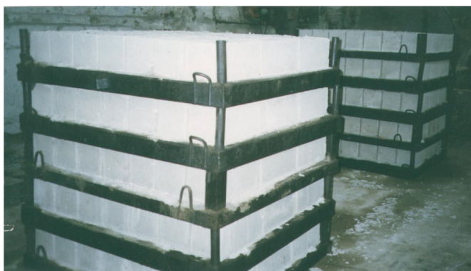
Рис. 2.12. «Этажерка» с поддонами и СКАБ для временного внутрицехового складирования
