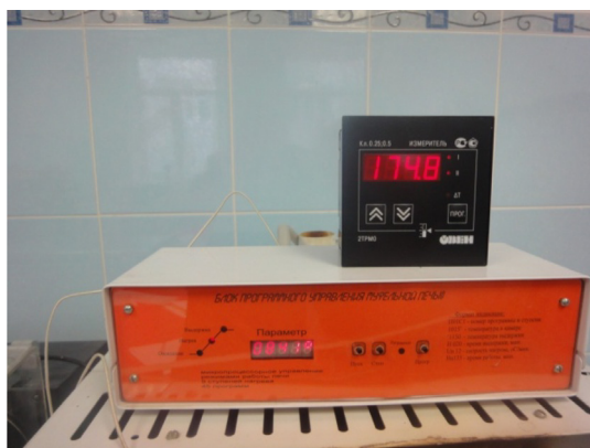
Рис. 1.35. Измеритель температуры микропроцессорный «ОВЕН 2ТРМО-Щ1.У» и блок программного управления муфельной печью
