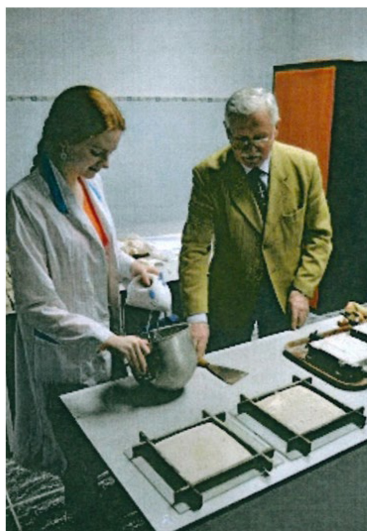
Рис. 1.30. Рабочий момент приготовления фрагментов огнезащитных экранов
