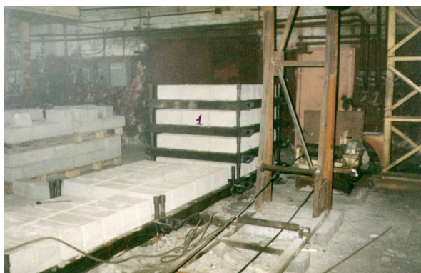
Рис. 2.11. Металлические поддоны с отформованными СКАБ после снятия рамок
