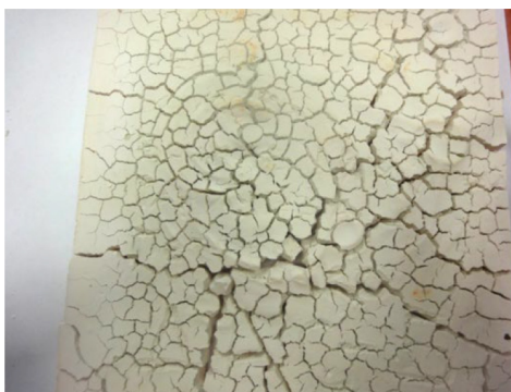
Рис. 1.38. Фрагмент гипсового экрана ГКЛ толщиной 20 мм после нагрева до 900 °С
