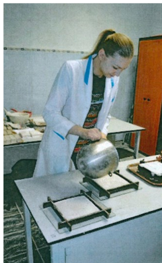
Рис. 1.30. Рабочий момент приготовления фрагментов огнезащитных экранов
