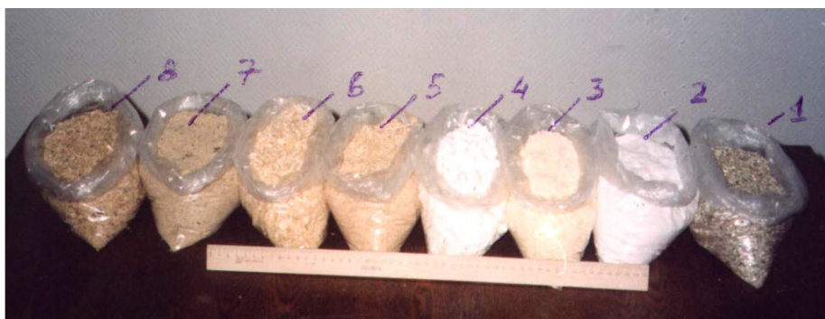
Рис. 2.17. Пористые заполнители для приготовления аэрированных легких бетонов: 1 – вспученный вермикулит; 2 – вспученный перлит; 3 – отходы (стружка) экструзионного пенополистирола; 4 – отходы пенополистирола; 5 – мелкозернистые опилки (хвойные); 6 – крупнозернистые опилки хвойные; 7, 8 – хвойные опилки после длительного хранения в отвалах (2–3 года)
