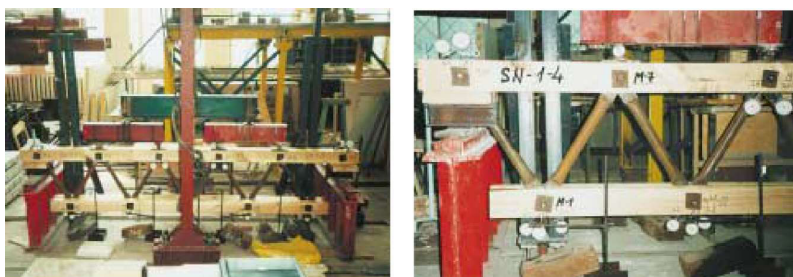
Рис. 4.14. Экспериментальное исследование фермы с параллельными поясами с когтевыми шайбами Технологического университета Вильнюса [63]
