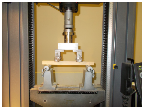
Рис. 3.11. Фотофиксация проведения испытаний на изгиб (фото установленного образца в машину для испытаний до начала проведения испытаний)
