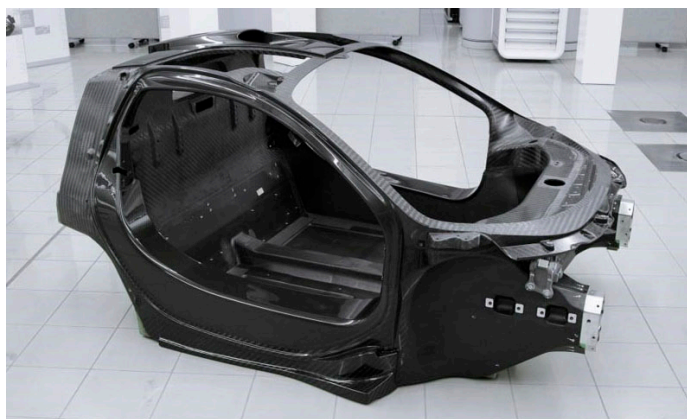
Рис. 2. Несущий монокок из композитных материалов
