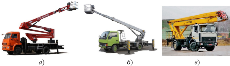
Рис. 1. Автовышки: а – с комбинированным механизмом подъема стрелы; б – с телескопическим механизмом подъема стрелы; в – с коленчатым механизмом подъема стрелы
