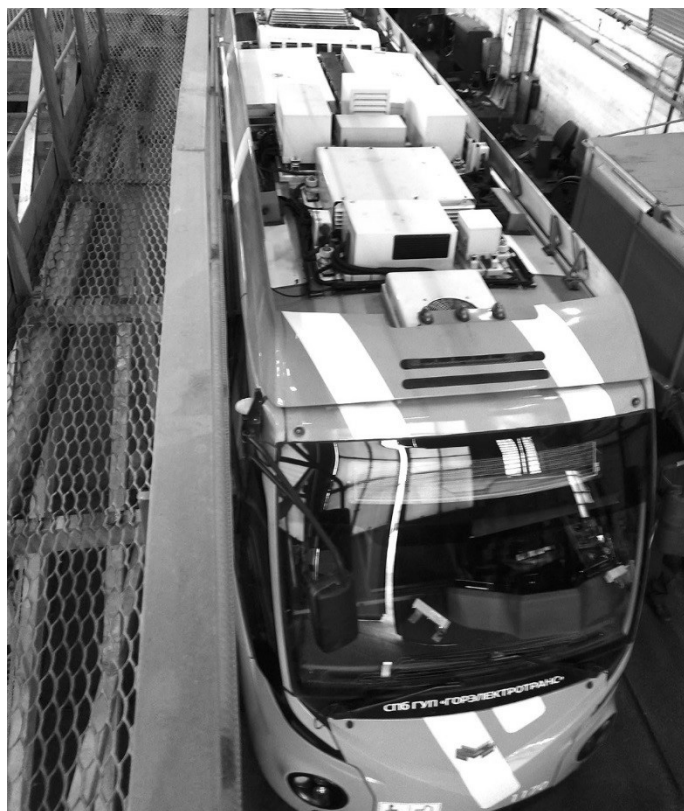
Рис. 9. Подмости для обслуживания тяговых батарей и устройств, расположенных на крыше электробуса
