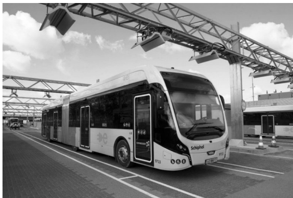
Рис. 4. Подключение к ЭЭС посредством пантографа, расположенного на крыше в передней части электробуса (концепция быстрой зарядки)
