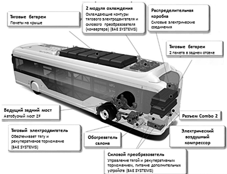
Рис. 7. Типичная компоновка электробуса (Iveco)
