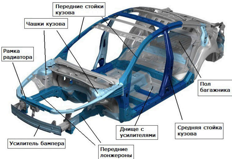
Рис. 1. Пример конструкции несущего кузова
