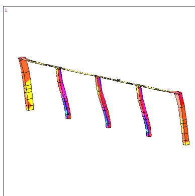
Рис. 13. Деформация колонн (масштаб деформации увеличен в 50 раз)
