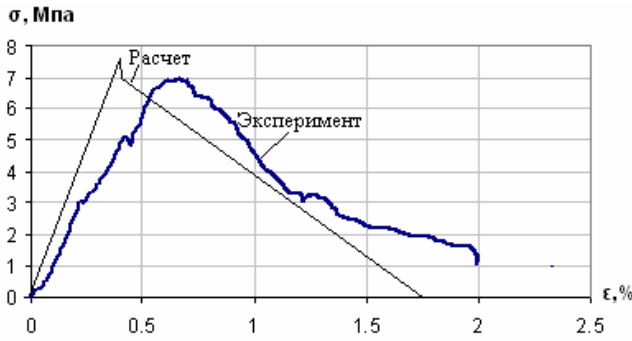
Рис. 5. Полная диаграмма деформирования образца при сжатии
