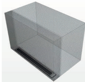
Рис. 2. Расчетная сетка помещения при высоте остекления 3,0 м
