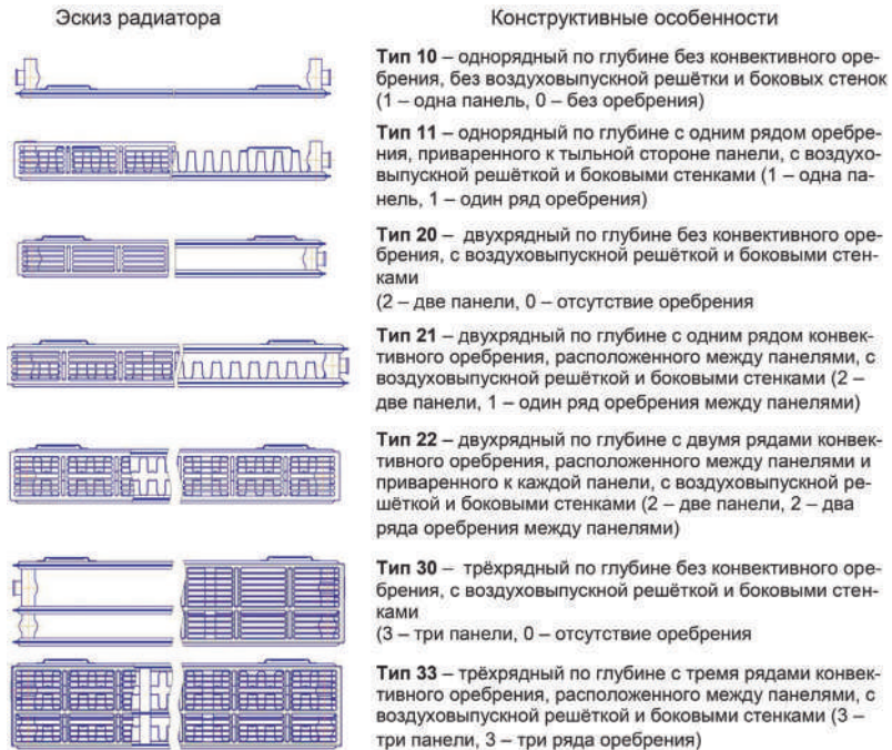
Рис. 2. Обозначение типов стальных панельных радиаторов
