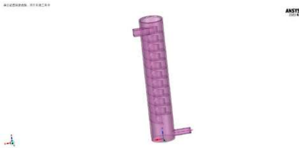
Рис. 1. Геометрия расчетной области шахты со спиральным лотком
