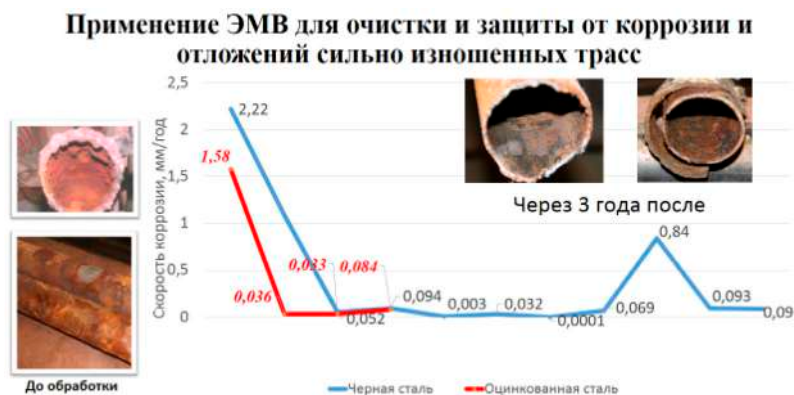
Рис. 7. Применение ЭМВ для очистки и защиты от коррозии и отложений сильно изношенных трасс
