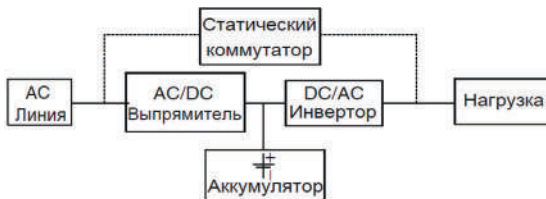
Рис. 1. Блок-схема статического СБП
