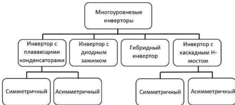
Рис. 1. Классификация многоуровневых инверторов
