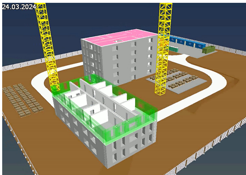
Рис. 3. 4D-модель возведения сборно-монолитного каркаса жилого здания
