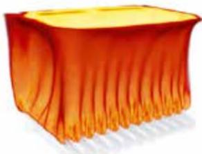
дель наглядно демонстрирует изменения параметров газозвушной смеси при движении по газогорелочному устройству и на выходе из него. С помощью второй программы было выполнено моделирование процесса горения. Нам было важно понять, как будет распределяться температурное поле, и будет ли теплообменник равномерно прогреваться. На разработанное изобретение был получен патент Российской Федерации.
