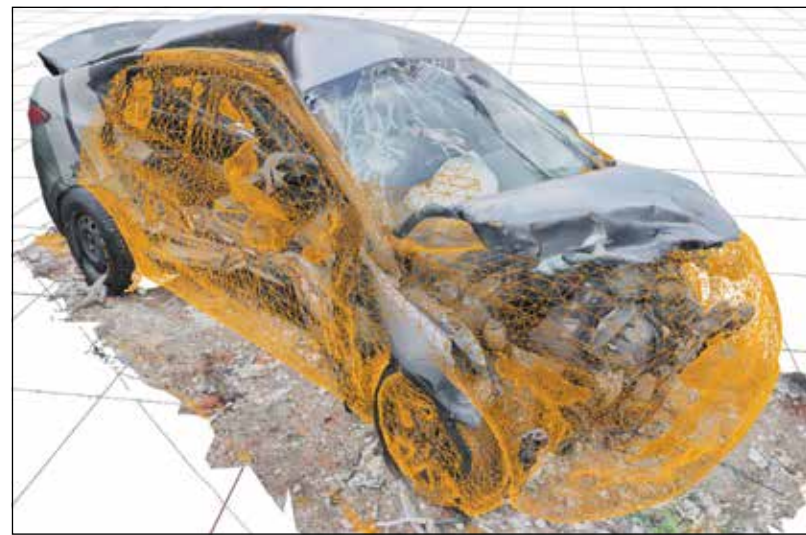
Результат совмещения 3D-моделей деформированного и недеформированного состояния автомобиля Hyundai Solaris
