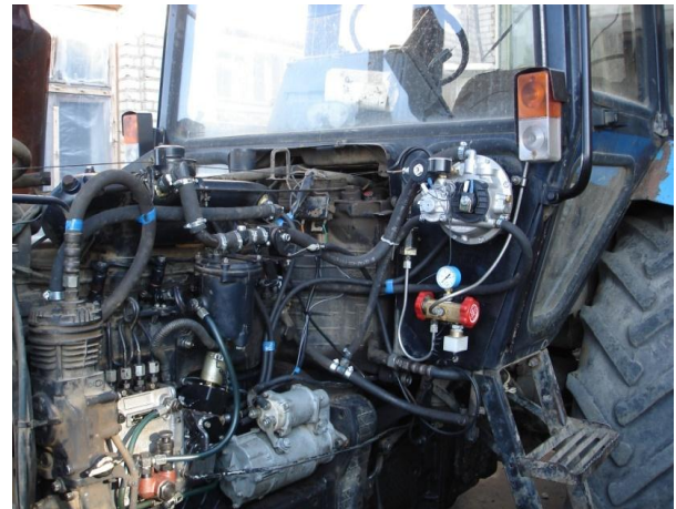
Рис. 10. Компонировка основных узлов системы питания на газодизельном тракторе МТЗ-82
