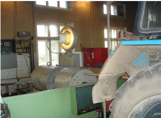
Рис. 9. Газодизельный колёсный трактор МТЗ-82 с газодизелем Д-243 на испытательном стенде ФГУ «Северо-Западной МИС»
