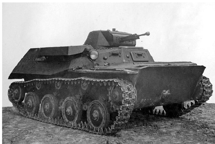
Рис. 6. Малый плавающий танк Т-40
