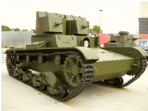
Рис. 3. Легкий двухбашенный танк Т-26 с пулеметным вооружением
