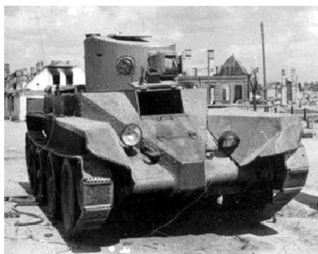
Рис. 2. Легкий пулеметный колесно-гусеничный танк БТ-2 (у данного танка пулеметы сняты)
