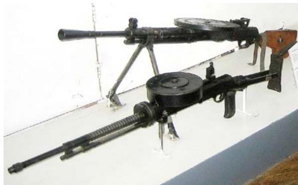
Рис. 1. Пулеметы ДП-27 и ДТ-29 (на переднем плане)
