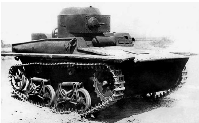
Рис. 4. Малый плавающий танк Т-37А
