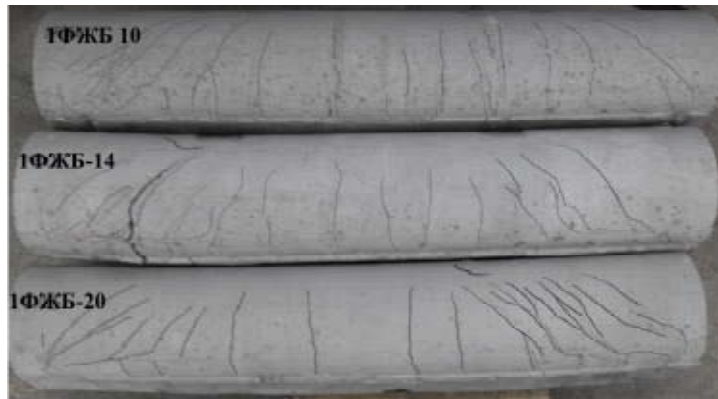
Рис. 16. Разрушение ФЖБ образцов. Серии 1ФЖБ-10, 1ФЖБ-14, 1ФЖБ-20, где первая цифра означает процент фибрового армирования, ФЖБ - фиброжелезобетон, последняя цифра - напряжение продольного сжатия
