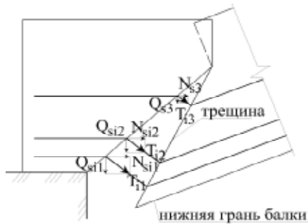
Рис. 7. Усилия в продольной арматуре
