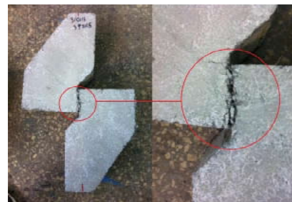
Рис. 12. Разрушение S-образных образцов
