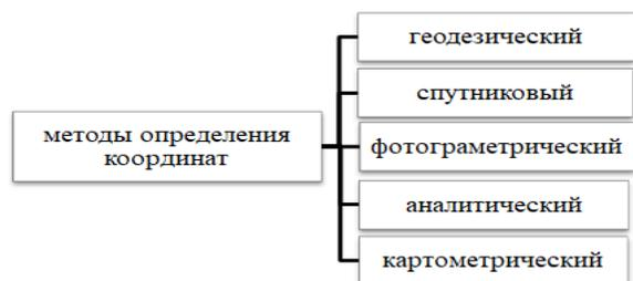
Рис. 1. Методы определения координат характерных точек ЗУ
