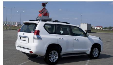
Рис. 2. Пример установки лазерного сканера на транспортное средство
