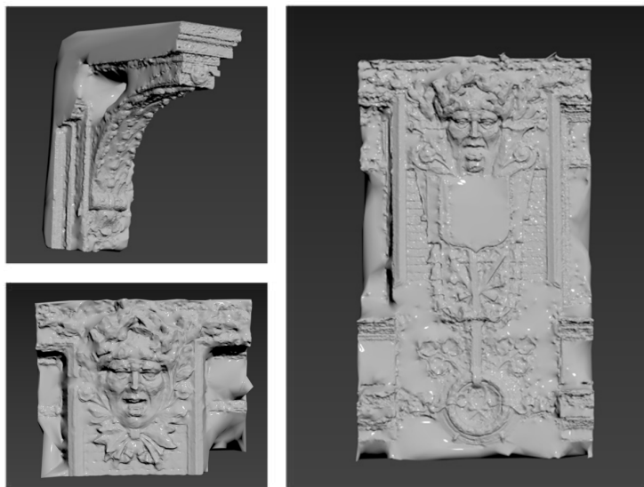
Рис. 7. Результаты лазерного сканирования декоративных частей фасадов здания
