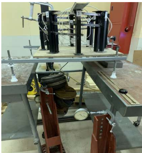
Рис. 7. Нагружение пролета № 3 до 120 кг
