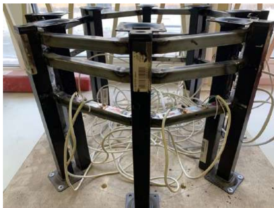
Рис. 6. Этап установки тензодатчиков на модель
