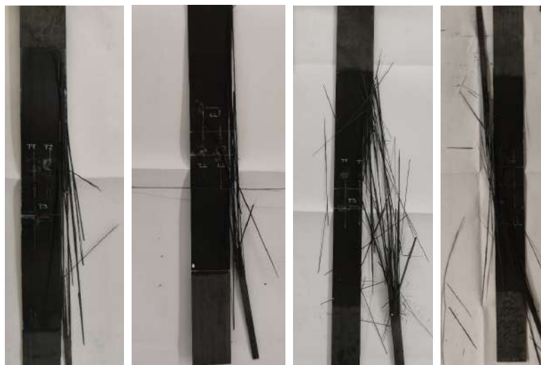
Рис. 8. Варианты разрушения образцов серии FRP-40 (2)
