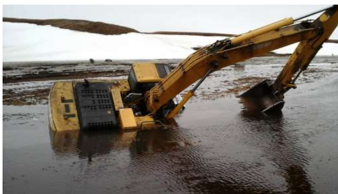
Рис. 4. Опрокидывание в воде
