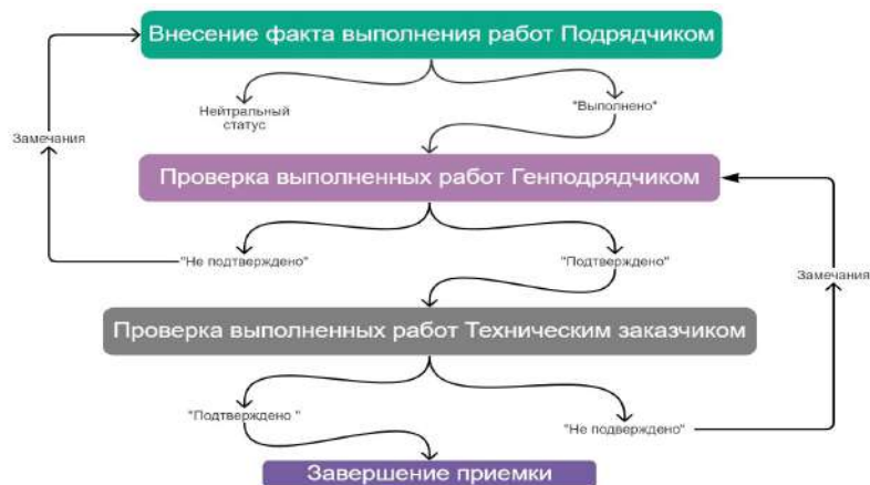
Рис. 4. Алгоритм проведения контроля хода строительства
