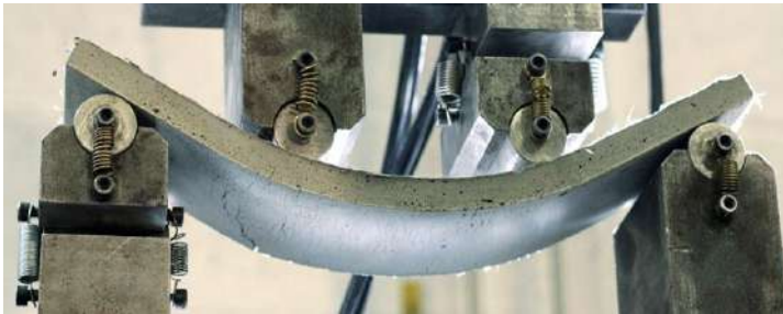
Рис. 3. Гибкий бетон ConFlexPave
