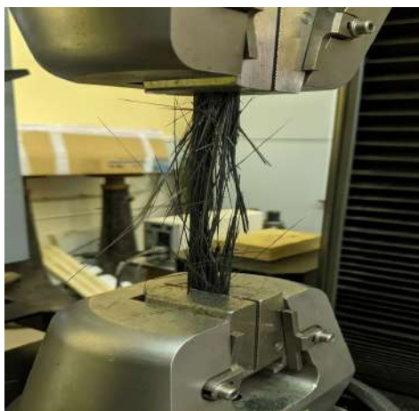
Рис. 5. Характерное разрушение образцов серии FRP-20
