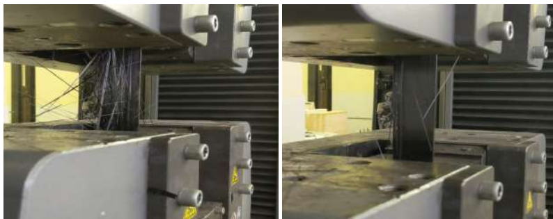
Рис. 7. Варианты разрушения образцов серии FRP-40 (1)
