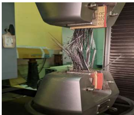
Рис. 6 Характерное разрушение образцов серии FRP-30
