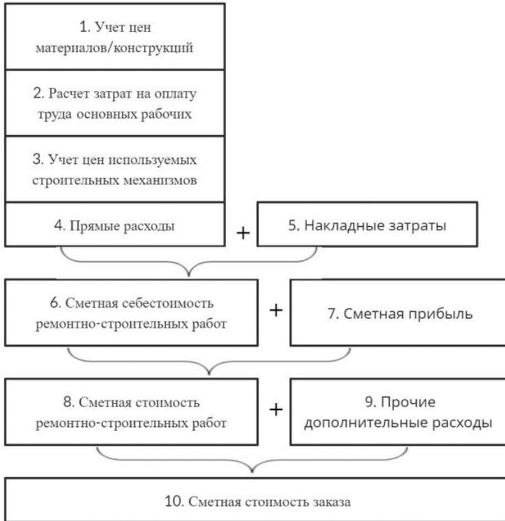
Рис. 1. Алгоритм формирования стоимости заказа на ремонтно-строительные работы
