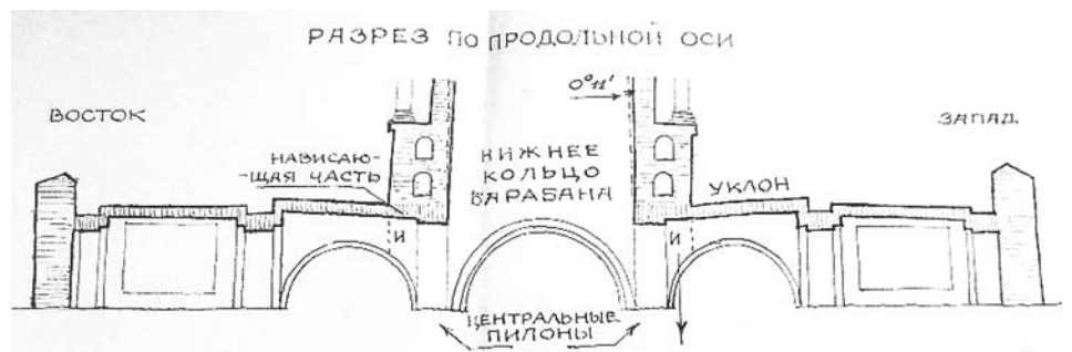
Разрез по продольной оси нижнего кольца барабана
