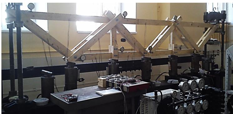
Рис. 3. Проведение испытаний конструкции фермы
