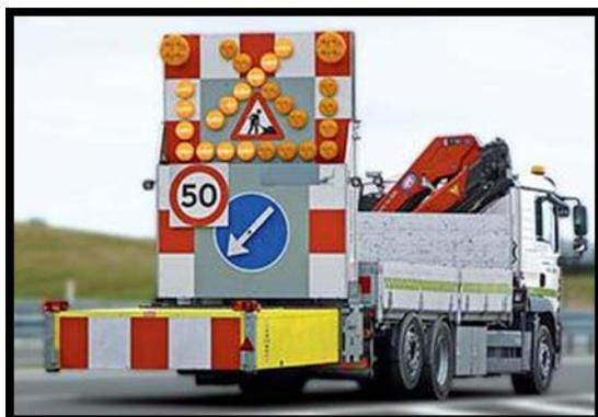
Рис. 1. Мобильная демпфирующая установка на грузовом автомобиле
