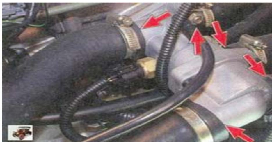
Рис. 2. Шланги, установленные на корпусе термостата (фрагмент иллюстрированной карты №1 операции 1.2.а)
