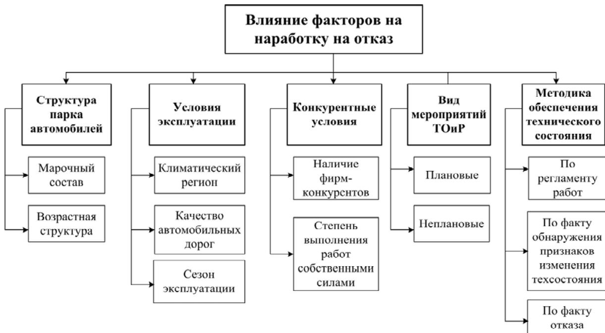
Рис. 1. Классификация факторов, влияющих на наработку на отказ автомобилей
