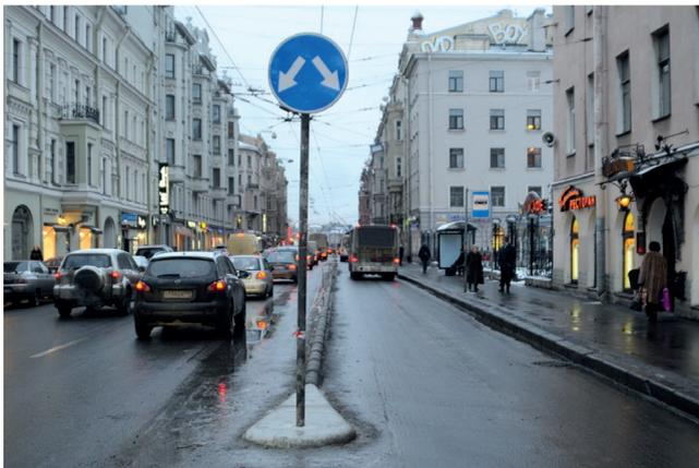
Рис. 5.8. Выделение полосы с помощью бордюрного камня
