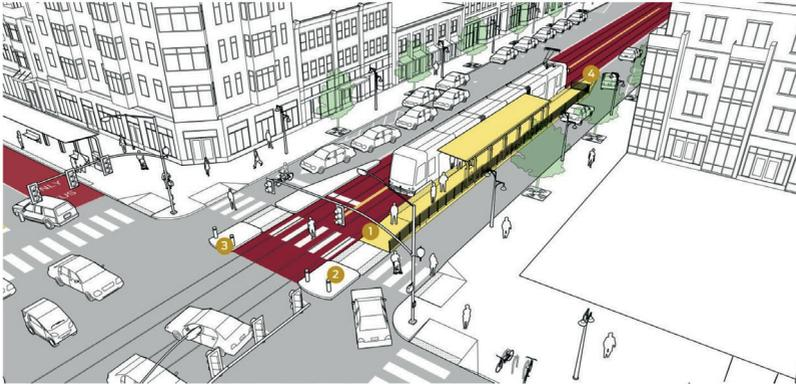
Рис. 5.13. Совмещенное движение трамваев и автобусов по трамвайной линии:
