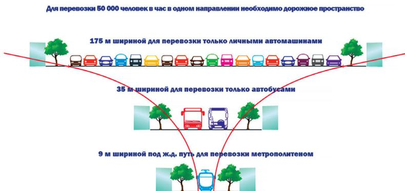
Рис. 5.6. Сравнение дорожного пространства, необходимого для перевозок различным транспортом
