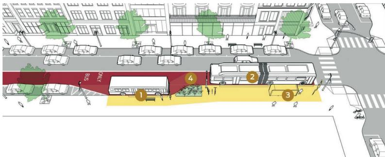
Рис. 5.11. Устройство кармана для межрейсового отстоя ПС:
