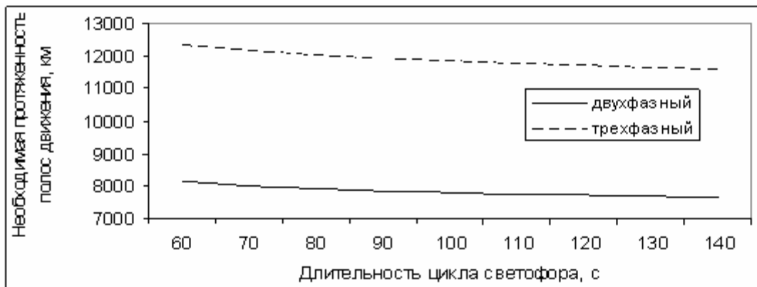
Рисунок 10 - Зависимость необходимой протяженности полосы движения для участка ДС, оборудованного СО с двух- и трехфазными циклами СР от длительности цикла светофора.
