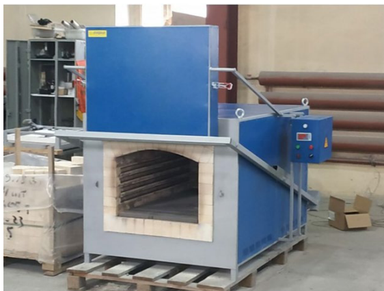
Рис. 13. Программируемая муфельная печь КЭП-ZV100/1100
