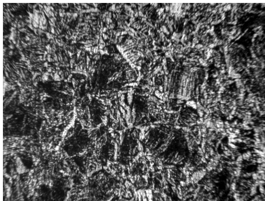
Рис. 47. Микроструктура стыкового сварного соединения из стали Ст3 в зоне перегрева, \times 200
