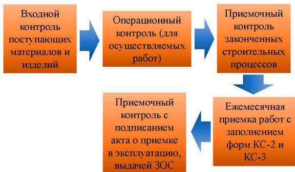
Рис. 1. Виды строительного контроля
