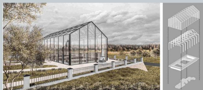
Рис. 11. Изображение и схема метода археологического окна для фундамента храма Михаила Архангела в д. Новопятницкое
