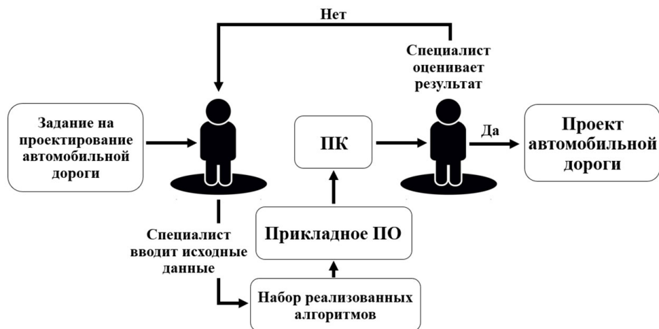
Рис. 2. Современный подход к проектированию автомобильной дороги
