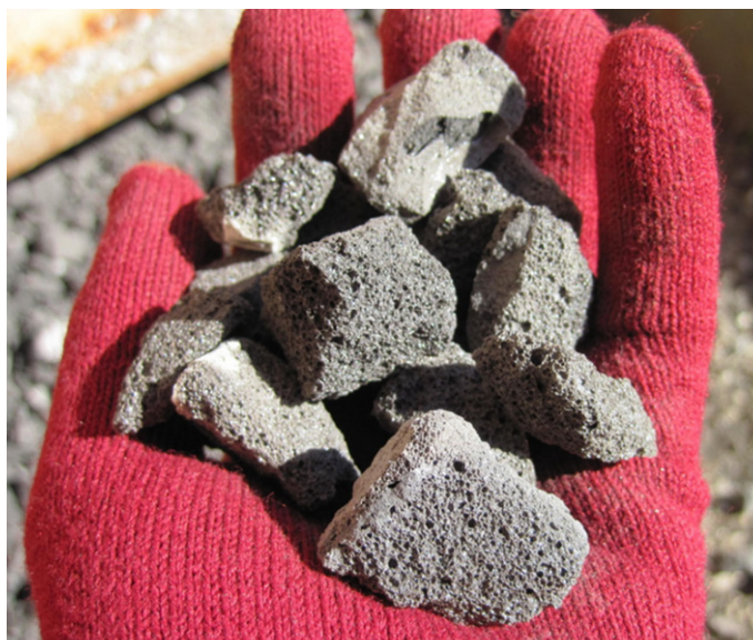
Рис. 1. Пеностеклянный щебень после дробления
