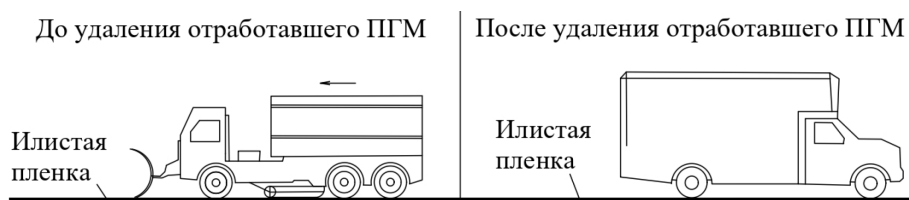
Рис. 3. Изображение илистой пленки до удаления отработавшего ПГМ и после
