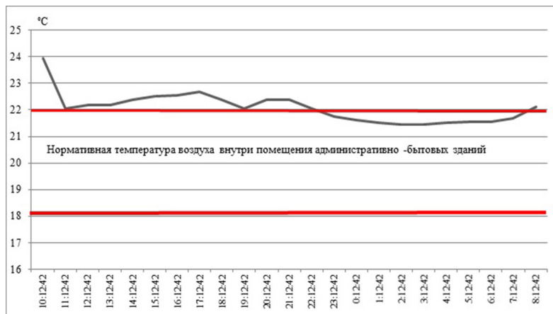
Рис. 2.31. Изменение температуры воздуха внутри помещения АБК
