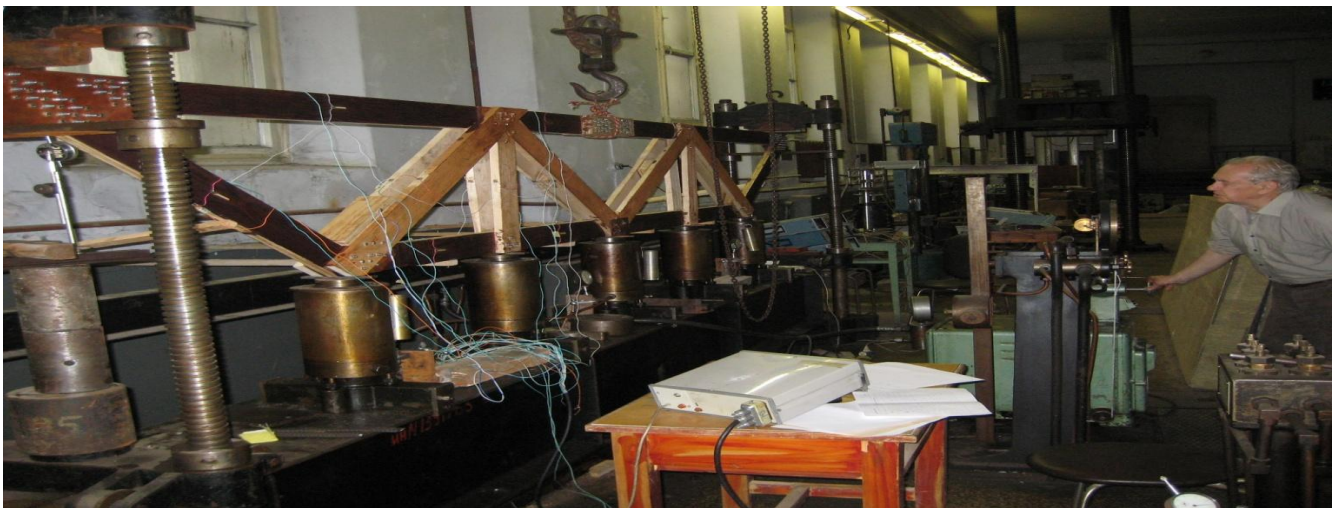
Рис.9. Натурная конструкция фермы малого пролета.
