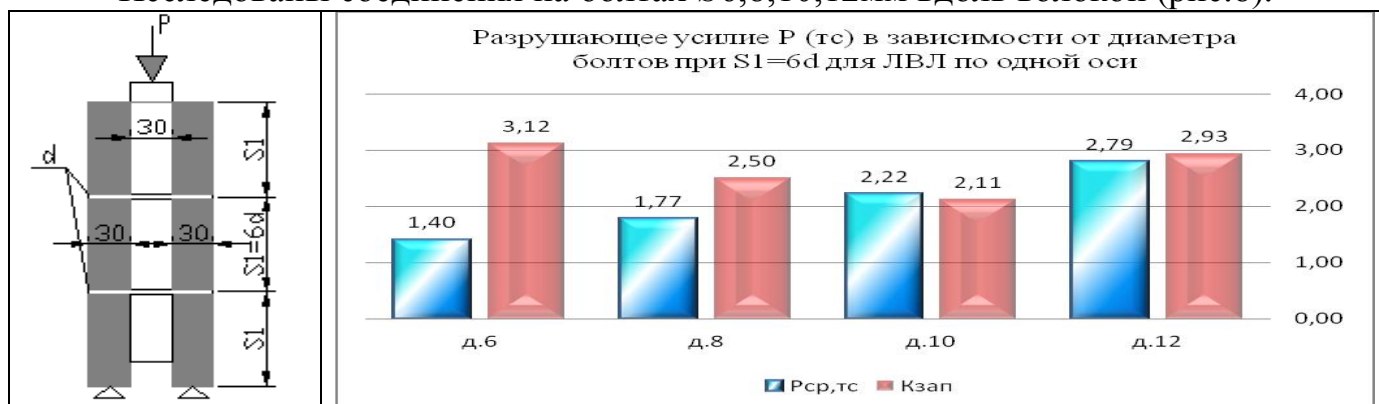
Рис.8. Диаграмма зависимости разрушающей нагрузки P_{max} и коэффициента запаса K_{зап} от диаметра болта.
