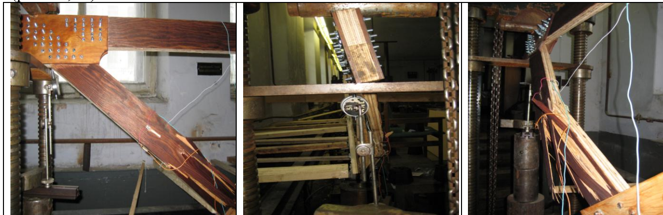
Рис.10. Фото-фиксация разрушения опорного подкоса.
