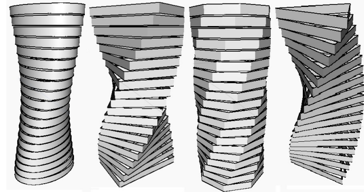
Рис. 3. Отображение геометрии в Dynamo , автоматический поворот каждого этажа
