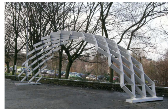
Рис. 1 (начало). Каркас арки из текстиль-бетона. Опытная модель [9]
