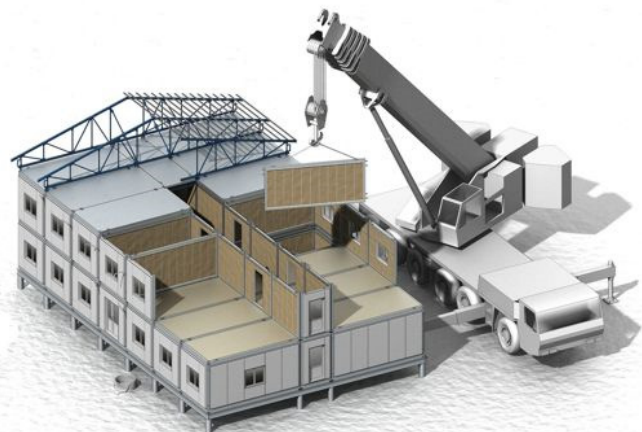
Рис. 4. Визуальный вариант сборки мобильного здания из конструктивных элементов на основе BIM-технологии [6]
