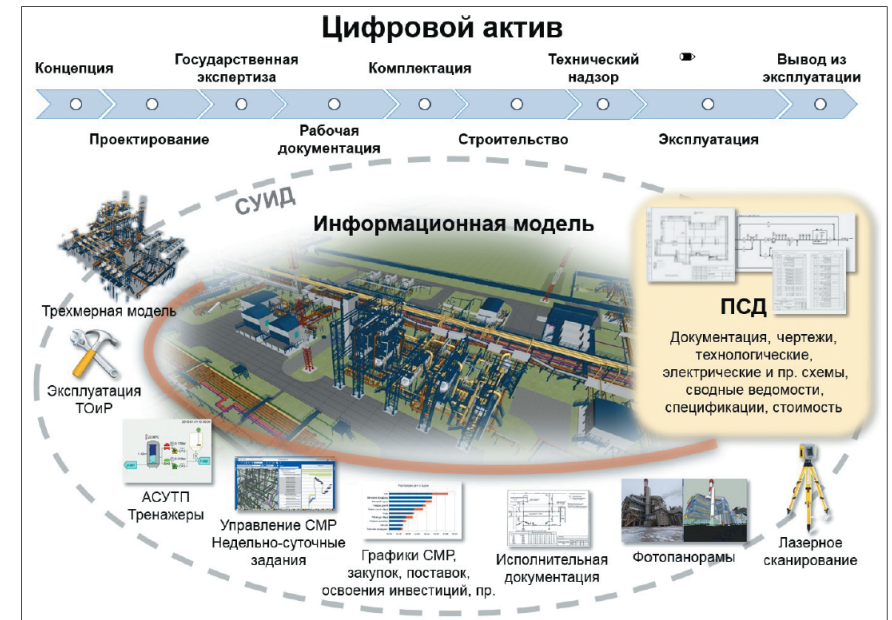
Рис. 2. Схема создания цифрового актива на базе СУИД НЕОСИНТЕЗ и загруженной в нее информационной модели объекта
