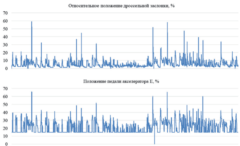
Рис. 1. Сопоставление графиков относительного положения дроссельной заслонки и положения педали акселератора по времени.
