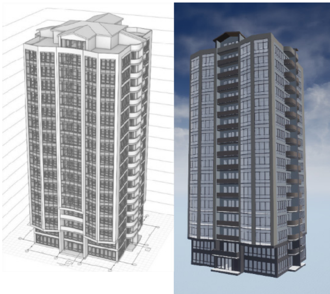
Рис. 2. Сравнение встроенных средств визуализации Renga (слева) и результата работы модуля интерактивной визуализации (справа)
