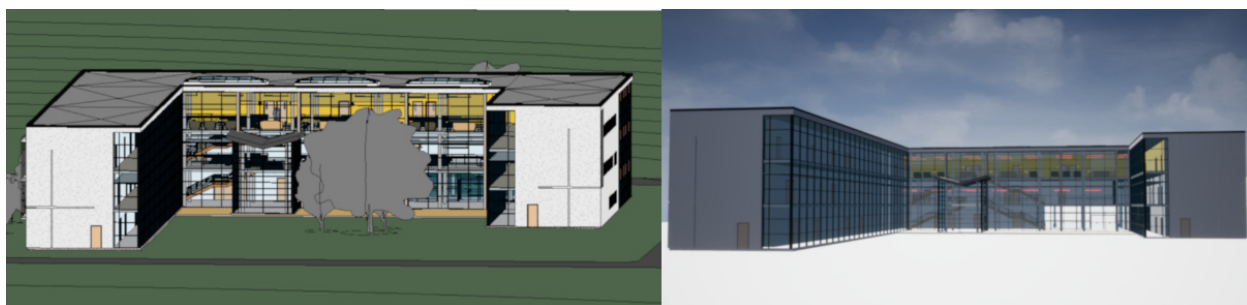
Рис. 3. Сравнение встроенных средств визуализации Revit (слева) и результатов работы модуля интерактивной визуализации (справа)
