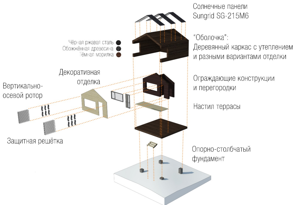
Рис. 3. Взрыв-схема устройства типовой ячейки
