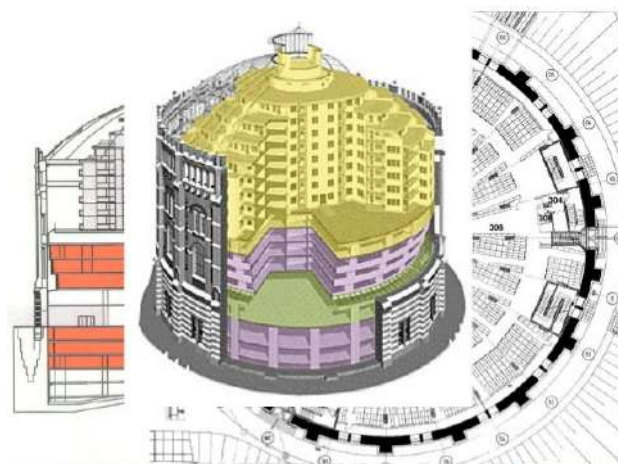
Рис. 3. Проект реконструкции газометра D
