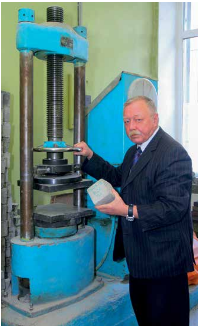
Пресс для определения прочности при сжатии строительных материалов
