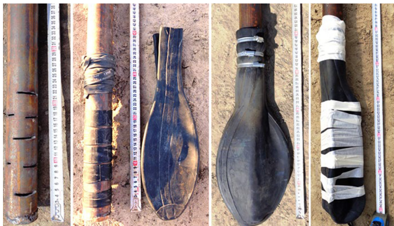
Рис. 2. Общий вид резиновой мембраны-стакана
