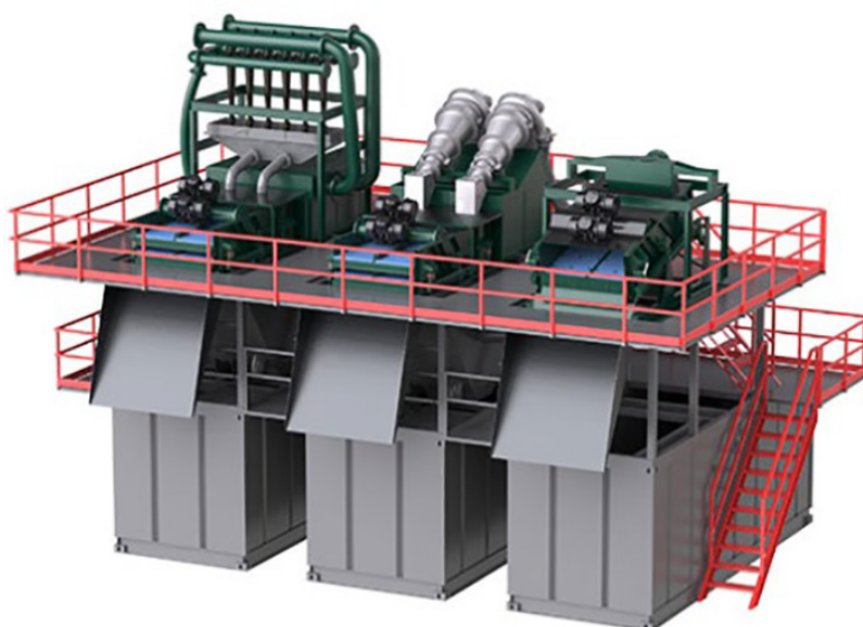
Рис. 2. Комплекс подготовки и регенерации бентонитового раствора
