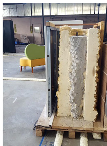
Рис. 4. Разрез стенки, изготовленной на принтере Batiprint3D
