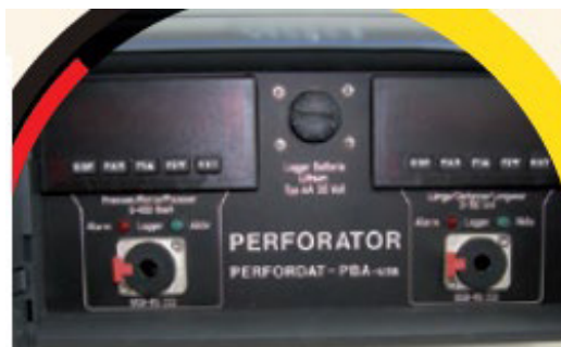
Рис. 7. Измерительная система «Perfordat PBA»
