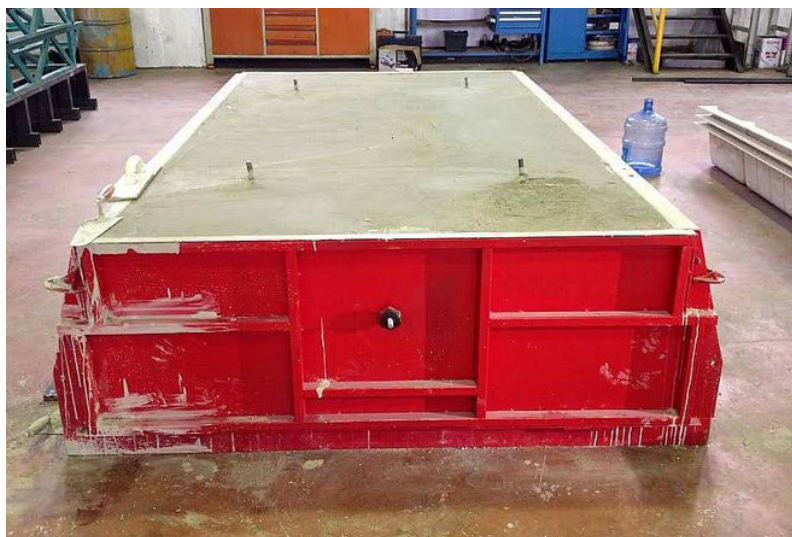
Рис. 2. Замоноличивание универсальной панели
