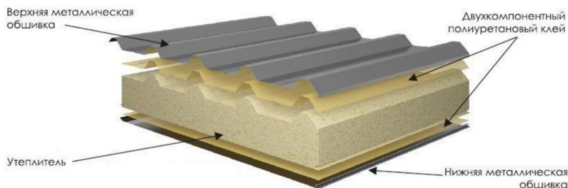
Рис. 1. Конструкция сэндвич-панели
