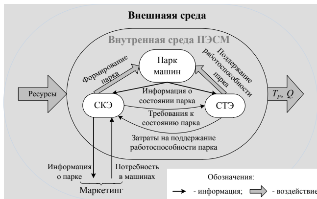
Рис. 1. Системное представление о ПЭСМ: СТЭ – система технической эксплуатации; СКЭ – система коммерческой эксплуатации; T_p – наработка парка машин на объектах за расчетный период; Q – объем выполненных работ за расчетный период
