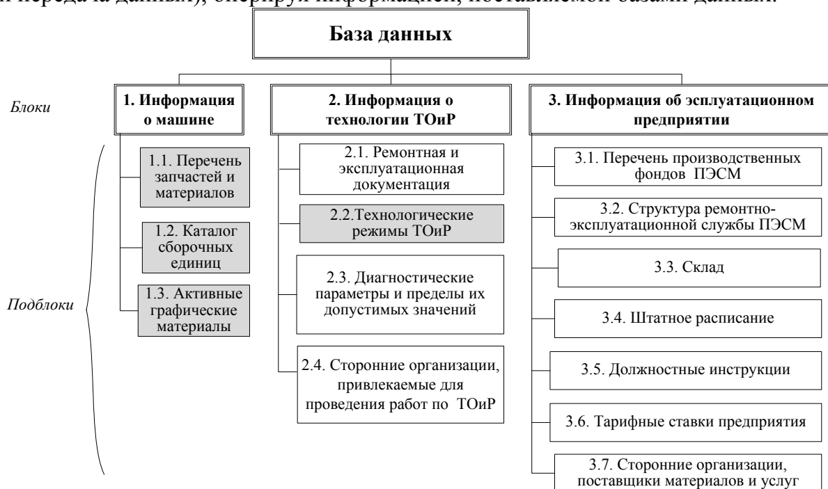
Рис. 25. Структура информационной базы технической эксплуатации строительной машины
