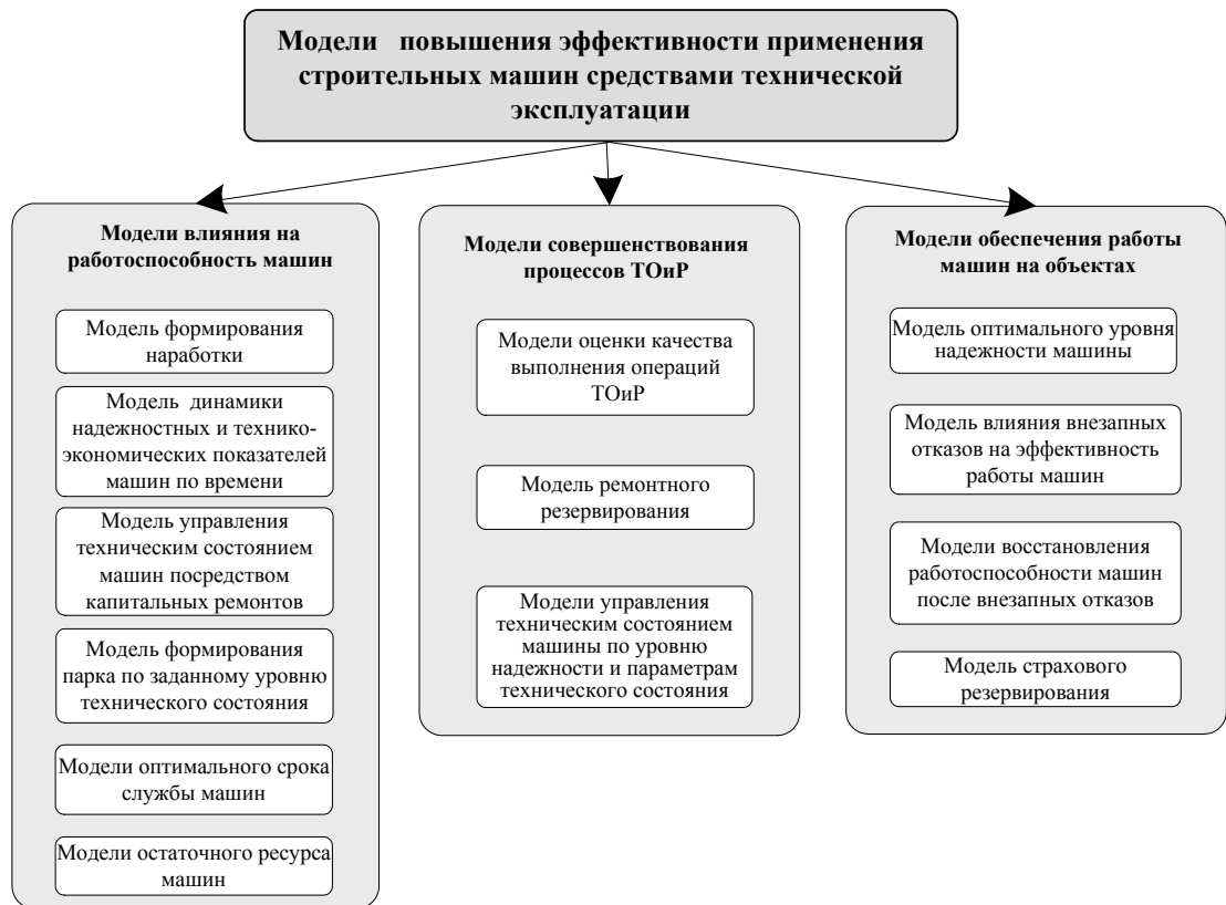
Рис. 7. Комплекс моделей влияния СТЭ на формирование эффективности применения строительных машин
