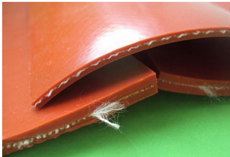
Рис. 4. Материал пневматической подушки (резина, армированная нейлоновыми шнурами)
