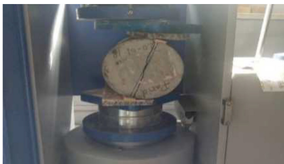
Рис. 8. показана 28-дневная прочность на растяжение полипропиленового фибробетона
