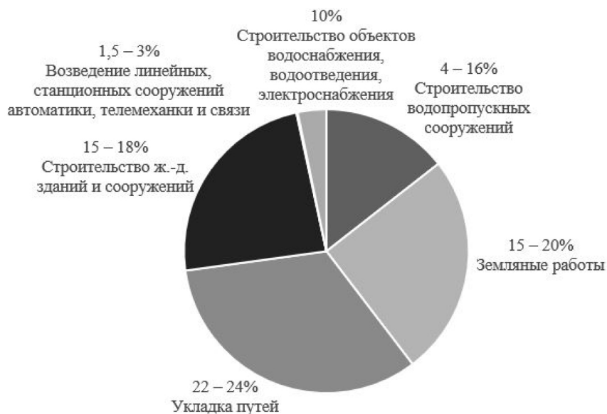
Рис. 4. Удельная стоимость работ основного периода в процентах от общей стоимости строительства железнодорожной линии
