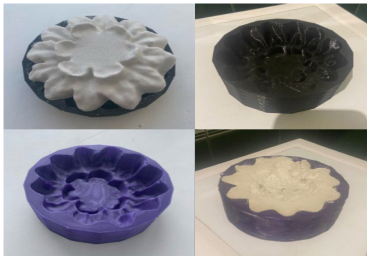
Рис. 5. Результат использования формы из «PETG» и «eFlex» пластика
