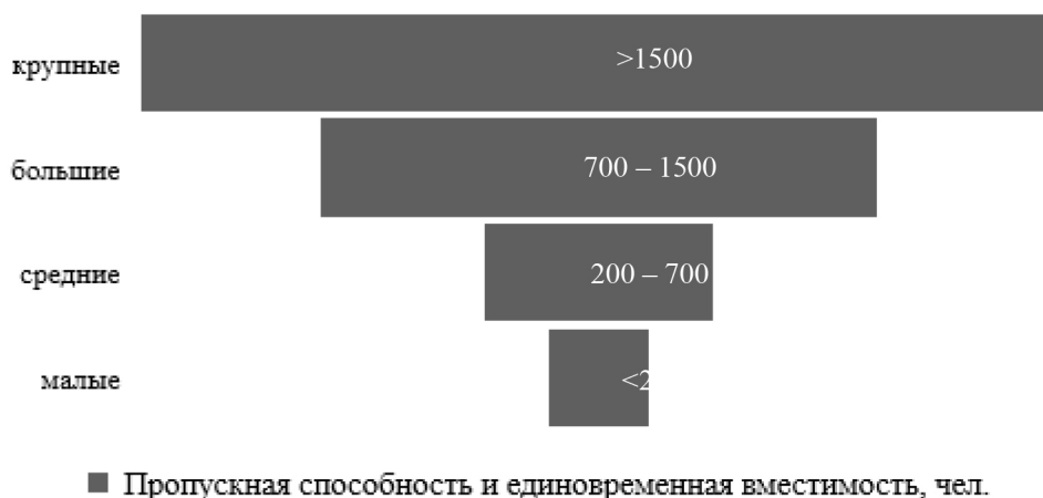
Рис. 1. Классификация вокзалов в зависимости от пропускной способности и единовременной вместимости пассажиров
