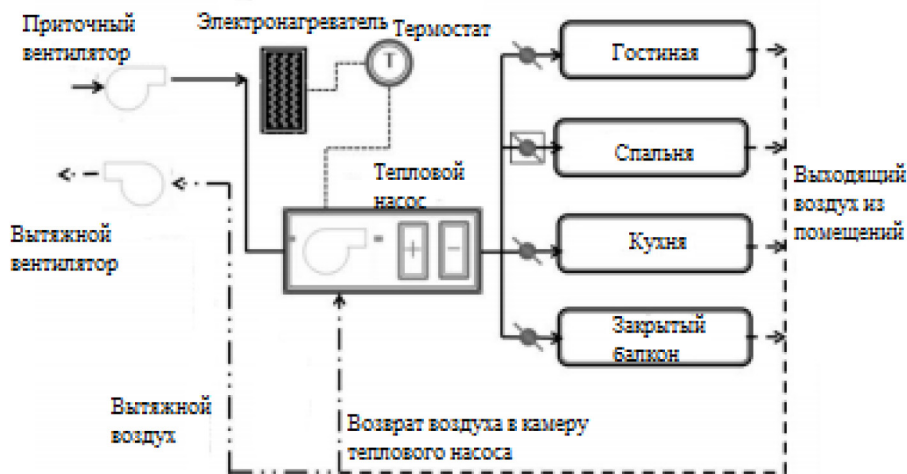
Рис. 4. Схема воздушного теплового насоса без теплообменника
