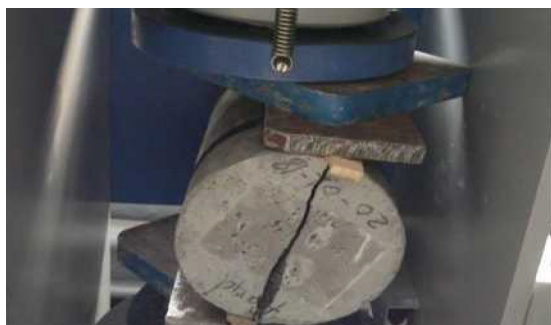
Рис. 7. показана прочность на растяжение обычного бетона после 28 дней
