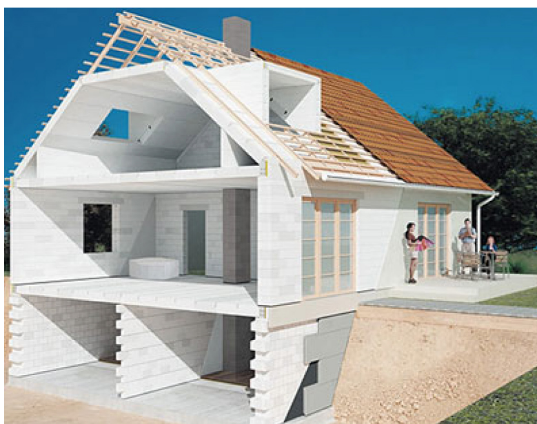
Рис. 3. Дом из газобетонного блока
