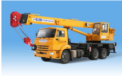
Рис. 1. Автомобильный кран КС-55713-В «Галичанин», грузоподъемностью 25 тонн
