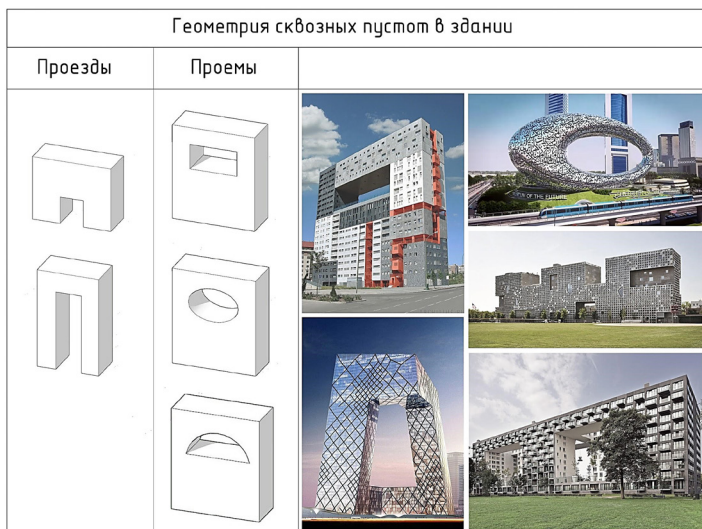
Рис. 2. Полости и проёмы в зданиях, влияющие на аэродинамические характеристики здания
