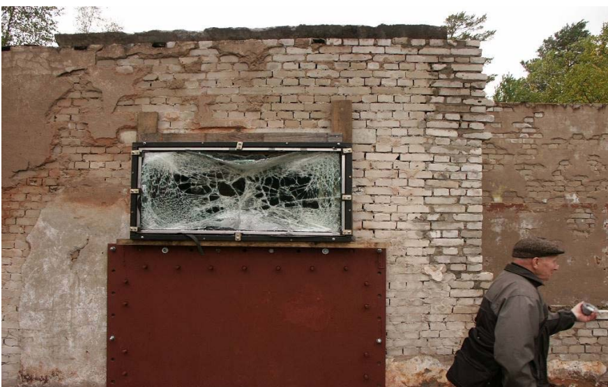
Рис. 2. Конструкция на основе 6 мм флоат стекла после второго взрыва
