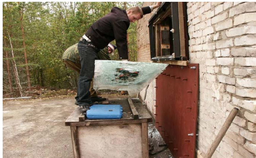
Рис. 3. Демонтаж конструкции на основе флоат стекла 6мм после второго взрыва 2 кг ТНТ
