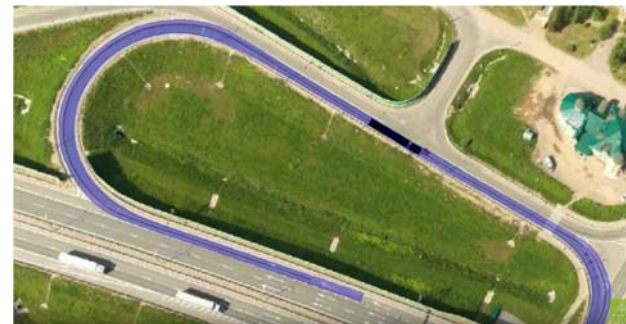
Рис. 4. Расчет коридоров движения транспортных средств на интернет карте
