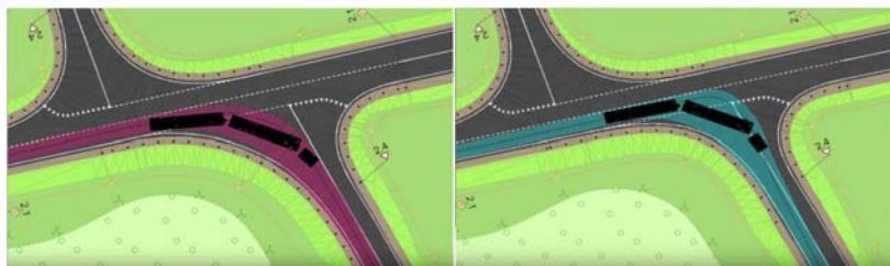
Рис. 3. Расчет коридоров движения транспортных средств
