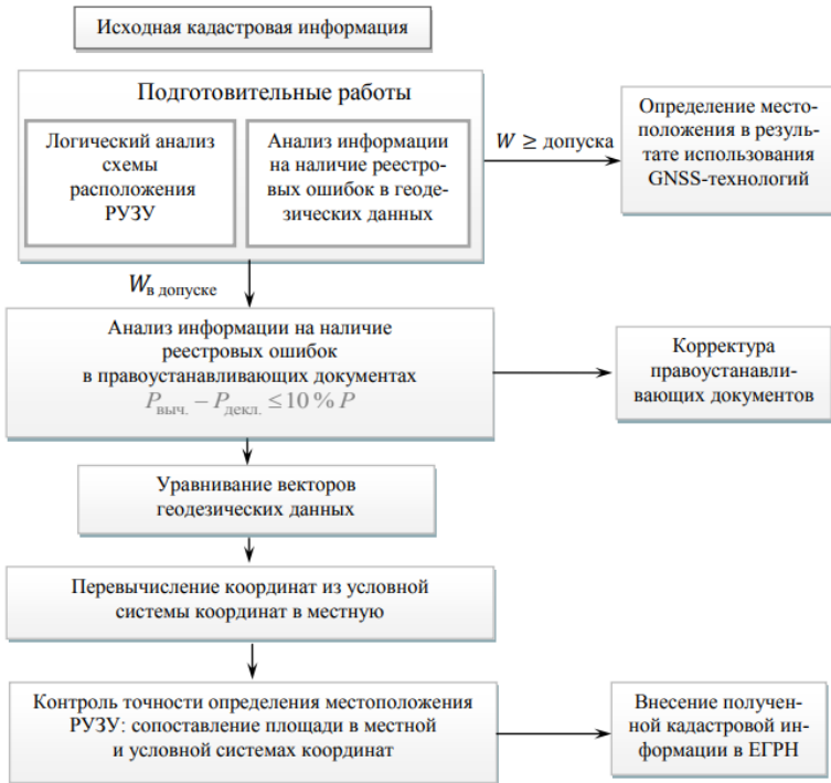
Рис. 3. Методика использования сочетания спутникового и аналитического методов [9]
