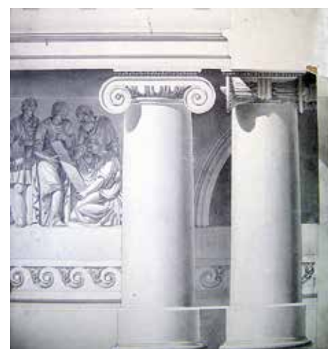
«Капитель и деталь антаблемента ионического ордера». Георгий Лоханов, студент II курса АФ Ленинградского инженерно-строительного института (ЛИСИ). Бумага, отмывка тушью. 50 × 70 см. 1950 г.
