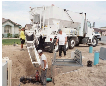
Рис. 3. Применение МБСУ Zimmerman Industries (США): а – на строительстве плотины; б – при ремонте статуи Свободы (Нью-Йорк, США); в – при ремонте взлетно-посадочных полос; г – при ремонте последствий аварии водопровода
