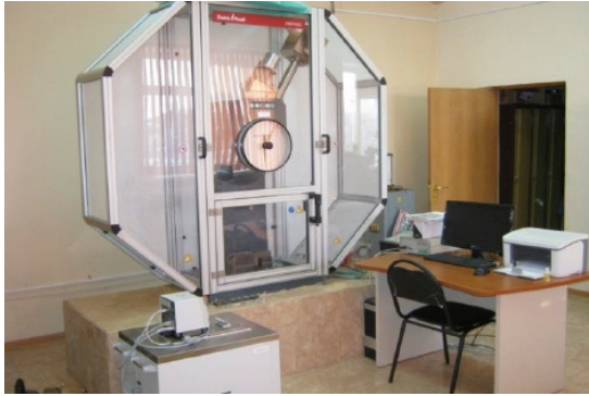
Рис. 3. Инструментированный маятниковый копер Amsler RKP450
