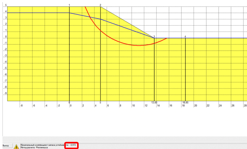
Рис. 3. Призма скольжения в откосе, построенная в ПК Scad-Откос , от собственного веса грунтовой призмы, гидродинамического давления воды, временной нагрузки на бровке котлована и сеймики ( K_{st} = 0,972 )
