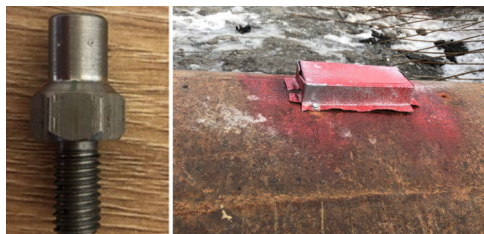
Рис. 3. Измерительная марка для полевого испытания (слева) и защитный кожух (справа)
