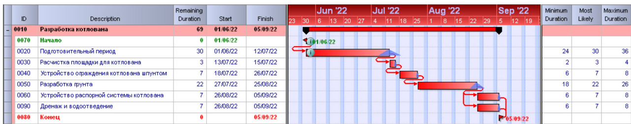
Рис. 1. Создание календарного графика по устройству котлована и определения продолжительности каждой работы с оптимистичным и негативным исходом в 20 % при помощи метода Монте-Карло
